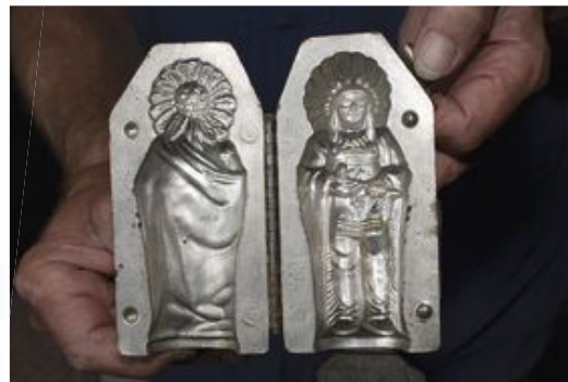
FRA TYSKLAND: De tyske formene som ble brukt på Asola kan åpnes og lukkes. Etter at sjokoladen hadde stivnet, ble den slått ut av formen. FOTO: HILDE KRISTIN GRØNLUND
