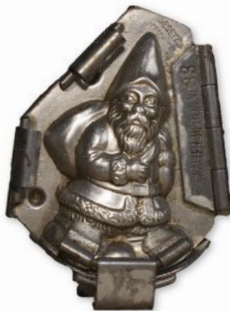
FRA TYSKLAND: De tyske formene som ble brukt på Asola kan åpnes og lukkes. Etter at sjokoladen hadde stivnet, ble den slått ut av formen. FOTO: HILDE KRISTIN GRØNLUND
